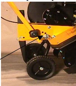
Транспортные колеса установлены на культиваторе. Регулировка выполнена с помощью замка. Потяните замок, и поднимите, или опустите культиватор за руль, пока правильная высота не будет найдена. Отпустите замок.
